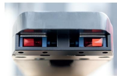
Recogida segura de la carga gracias a los sensores de distancia en la punta de la horquilla.
